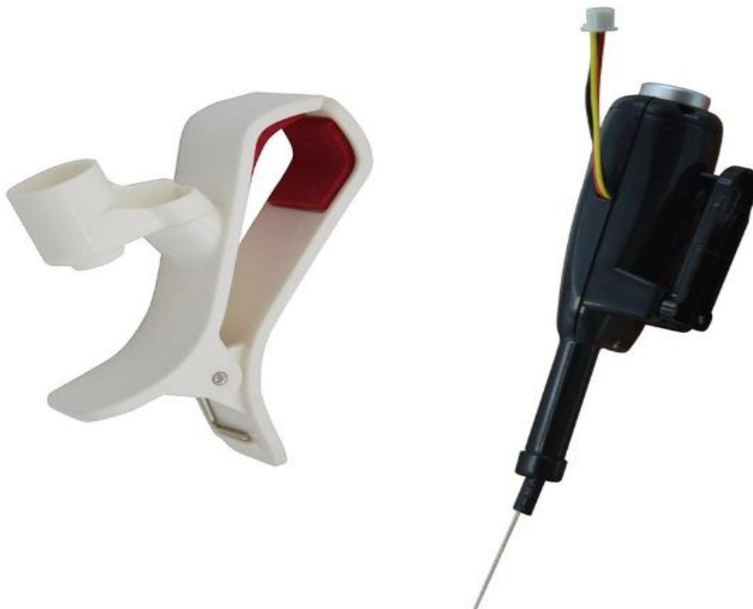
Самая популярная технология посредством которой реализуется FPV полёт. Устанавливается в основном на бюджетные дроны. Почти каждый квадрокоптер ценой меньше ста долларов, будет именно с FPV по Wi-Fi. Первая причина популярности это дешевый Wi-Fi передатчик который подключен к камере дрона, вторая – в комплектации отсутствует монитор, его роль будет выполнять смартфон или планшет. В случае с аналоговым оборудованием, беспилотник укомплектовывается дополнительно пультом с монитором или очками.
